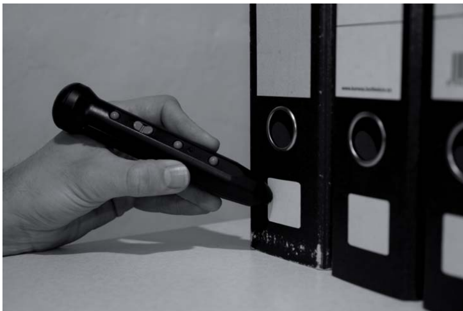
Obr. 2: PenFriend – pomůcka sloužící k označování předmětů (šanonny, potraviny, CD, dokumenty), k nalepovacím štítkům lze do pera namluvit hlasovou informaci (název potraviny, jméno alba atd.)
